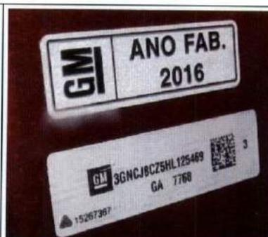
Figura 7 – Plaqueta e etiqueta com ano de fabricação e caracteres VIN.
