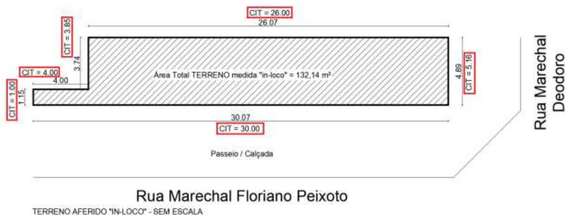
Figura 04: Medidas aferidas "in-loco" com auxílio de trena divergindo sistematicamente das medidas da Certidão de Inteiro Teor. As medidas destacas em retângulo vermelho são as medidas constantes em Certidão de Inteiro Teor.
