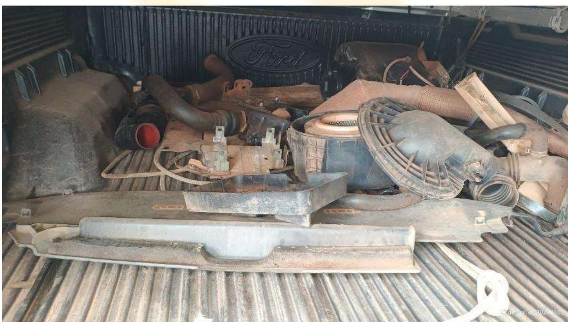
Na carroceria observa-se a caixa de filtro e o filtro de ar do motor, parte do sistema de arrefecimento e de alimentação, bem como, tampas de fechamento do compartimento do motor. O veículo conta com protetor de caçamba e capota marítima.
