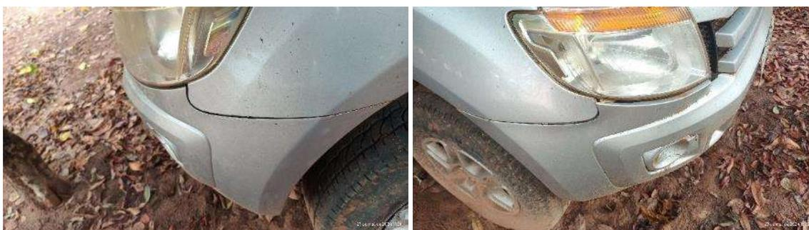
O para-choque dianteiro está levemente afundado havendo a necessidade de reparo na parte dianteira inferior da carroceria.
