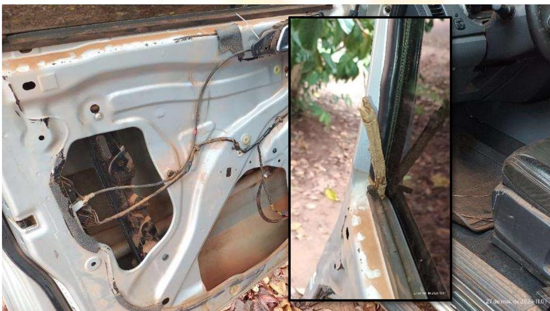
Internamente o veículo apresenta problema aparente no sistema de movimentação do vidro dianteiro esquerdo, o que justifica a remoção do seu painel de acabamento.
