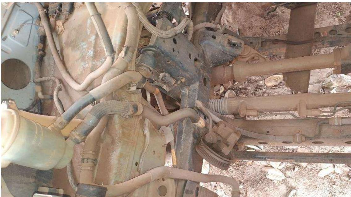
Observa-se a bomba de direção hidráulica desconectada do motor e a presença de fluido no reservatório.
